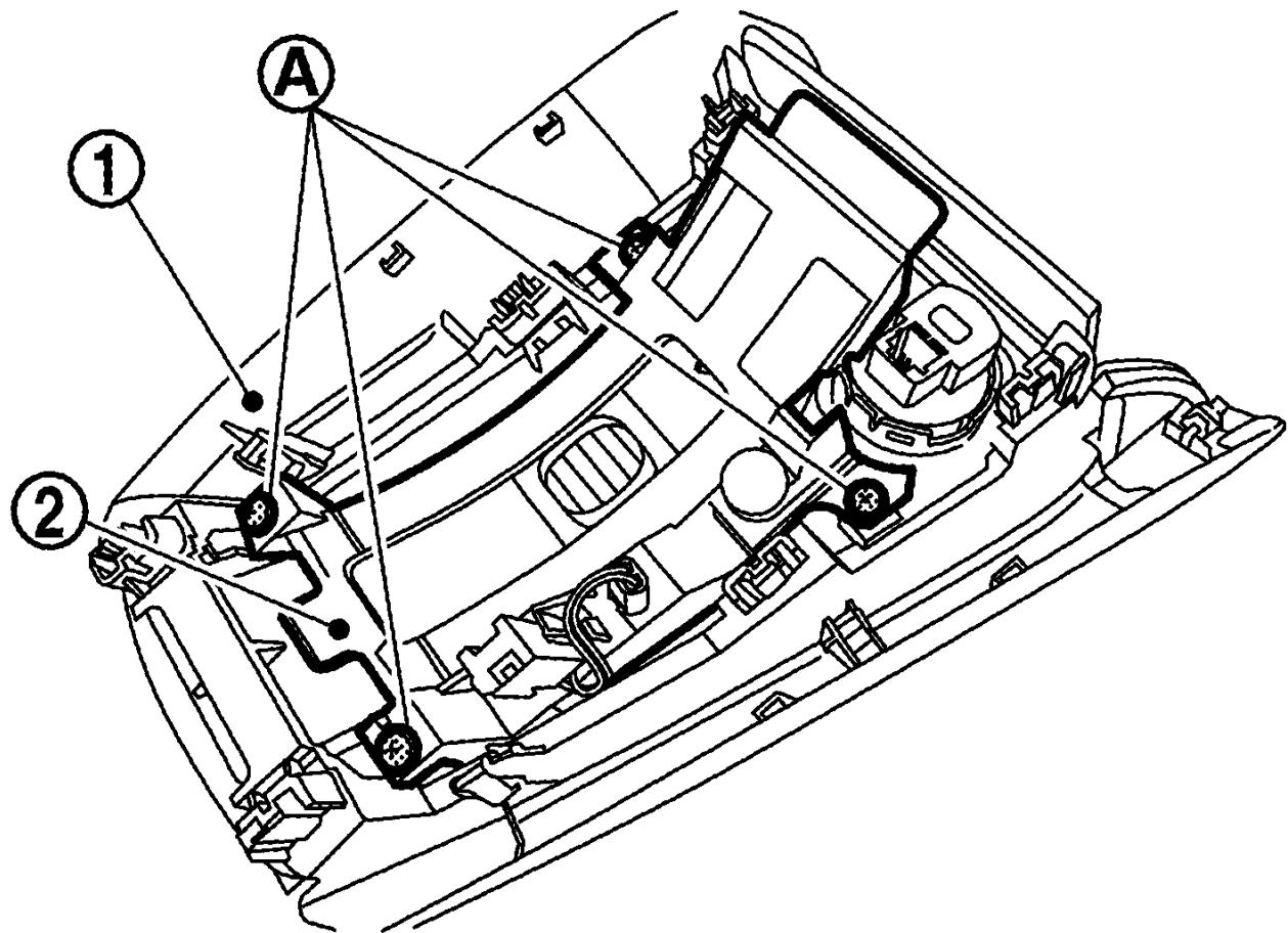
拆下螺丝 ①，然后从CVT控制台饰件 ① 上拆下按钮式点火开关 ②。
