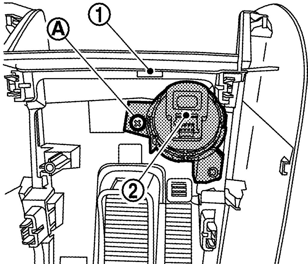
分开按钮式点火开关固定棘爪，然后从支架 ① 上拆下按钮式点火开关 ②。
